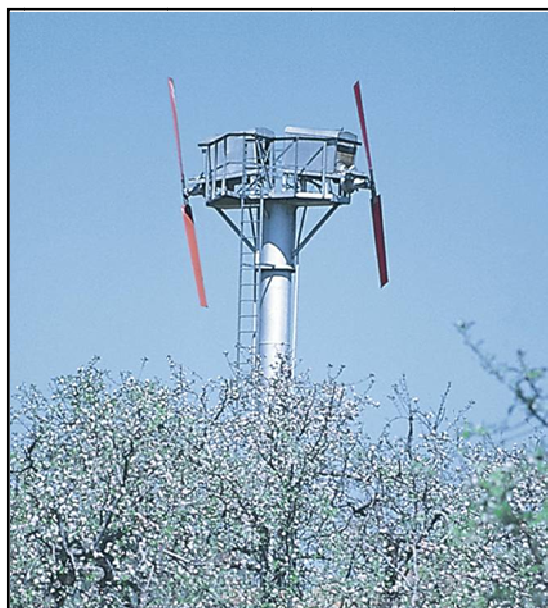
3. kép. Aktív fagyvédelem propelleres levegőkeveréssel (BEGYIK 2009 nyomán)
